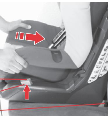
☞ Schieben Sie beide Rastarme **4** in die Einführhilfen **1**, bis die Rastarme auf **beiden Seiten** einrasten. „KLICK!“
