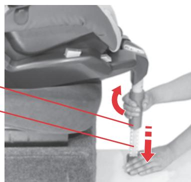
☞ Gire la empuñadura giratoria **9** en sentido contrario a las agujas del reloj y extraiga el pie de apoyo **6** hasta que esté apoyado firmemente sobre el suelo del vehículo.
