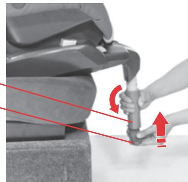
⇨ Поверните кнопку регулировки 9 против часовой стрелки и снова сдвиньте опору 6.
