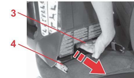
откидывающейся спинкой перед откидыванием спинки следует снять приемные приспособления.
