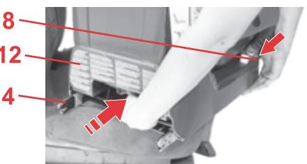
☞ Drücken Sie auf die orang Spanntaste **8** und schieben Sie gleichzeitig die Rastarme **4** wieder in das Sitzunterteil **12**.
